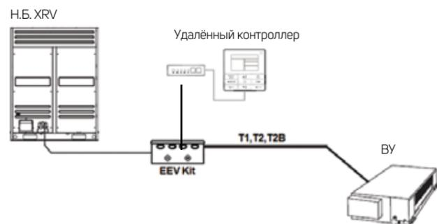
Регулировка температуры в помещении происходит с той же логикой, что и XRV: сравнивая температуру, фиксируемую датчиком T1, и заданную температуру Ts, можно запустить или остановить наружный блок, рассчитать требуемую тепловую мощность и управлять потоком хладагента через электронный расширительный клапан.
