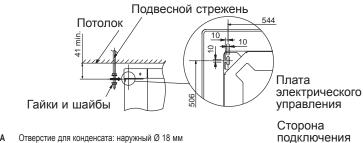
Отверстие для конденсата: наружный Ø 18 мм
